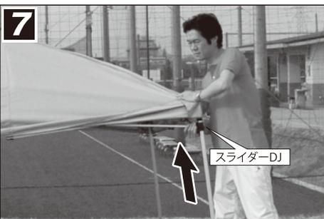
OUTER LEG にあるすべてのスライダ-DJ を、「パチン」と音がするまで押し上げます。
